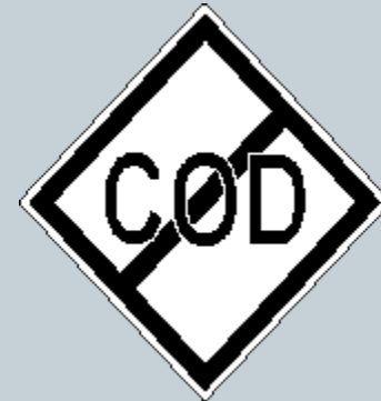
Fine zona codificata (ripetizione del segnale in cabina)
