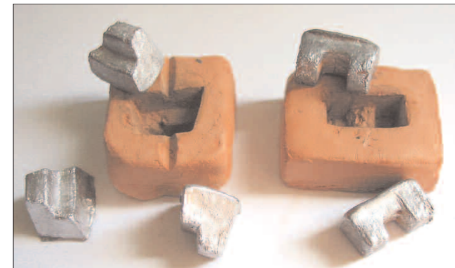
Figura 5 - Dagli stampi in Das ecco estratti i blocchetti di zavorra
