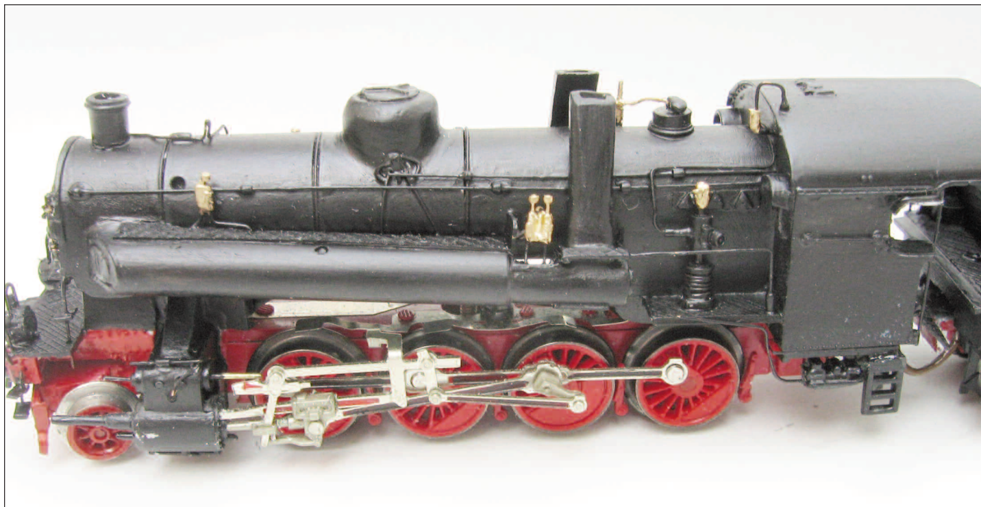
Una visione ravvicinata della caldaia e del preriscaldatore
